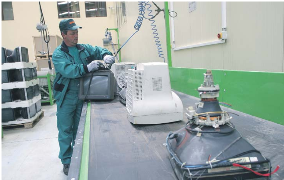
► В завода може да бъдат рециклирани 80 бр. кинескопа на час, тяхната обработка е част от едната му поточна линия. По другата върви възстановяването на хладилници
